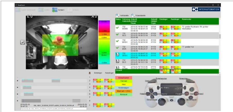
Abb. 3: VisualCount – eine spezialisierte Software der Firma Interautomation, um ein- und aussteigende Fahrgäste sowie Objekte effizient zu zählen.
